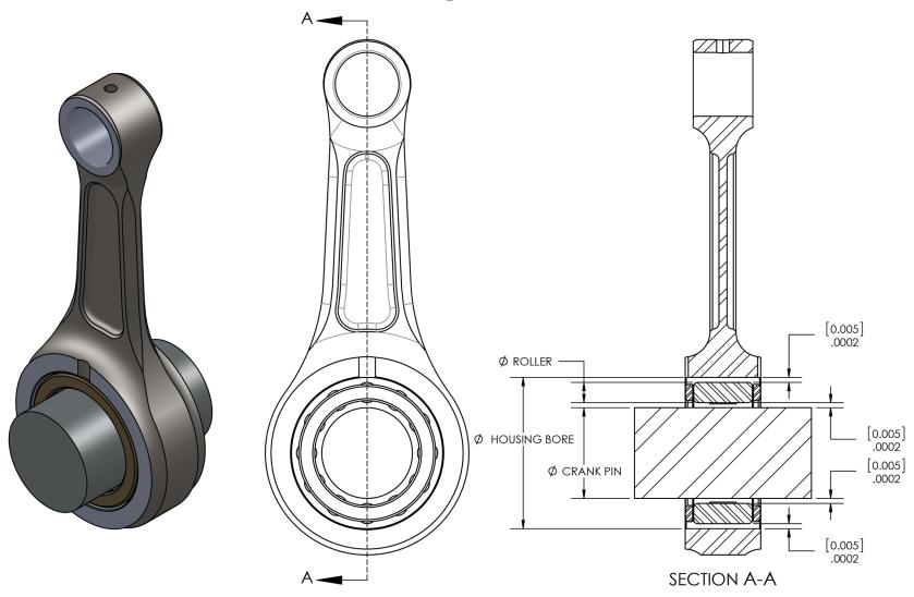
$\varnothing$  HOUSING BORE =  $\varnothing$  CRANK PIN + (2 ×  $\varnothing$  ROLLER) + 0.0008"  $\varnothing$  HOUSING BORE =  $\varnothing$  CRANK PIN + (2 ×  $\varnothing$  ROLLER) + 0.020 mm
